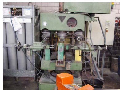
Zweihandbedienung, Schaltschrank Steuerung und Pneumatik, CO 2 Flaschenbündel
