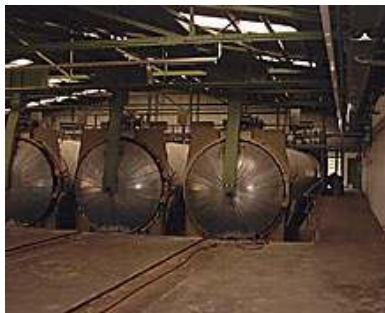
Autoklaven für Kalksandstein Produktion
